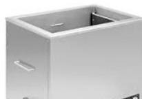
Bandelin RM 110 Sonorex Technik (600×450×450 мм, 110 л) промышленная отмывочная ванна
