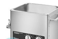
Bandelin BactoSonic 14.2 ультразвуковая ванна для удаления биопленок
